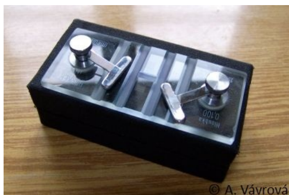
Obr. 25: Bürkerova počítací komůrka (archiv A. Vávrové)
